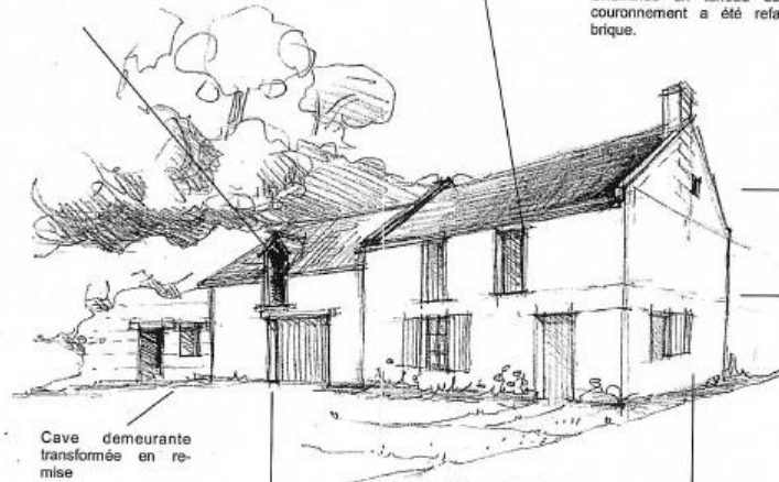
Bâtiment d'habitation sur deux niveaux couvert à deux pentes ou mono-pente, orientation Est Ouest. Pas de lucarne en général.
