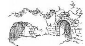
Adaptation de la cave de- moyenne : une façade en tuffeau ferme l'espace habitation. L'entrée de l'annexe est retravaillée en tuffeau appareillé.
